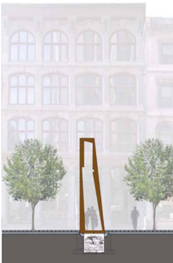
Des éléments d'acier reprennent le profil d'un mur de fortification directement au-dessus des vestiges.
